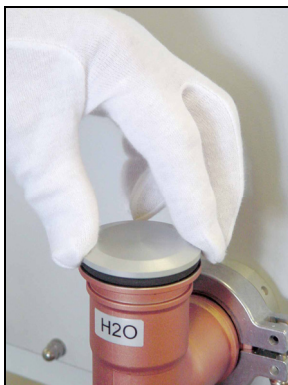
Insert dummy plug.
